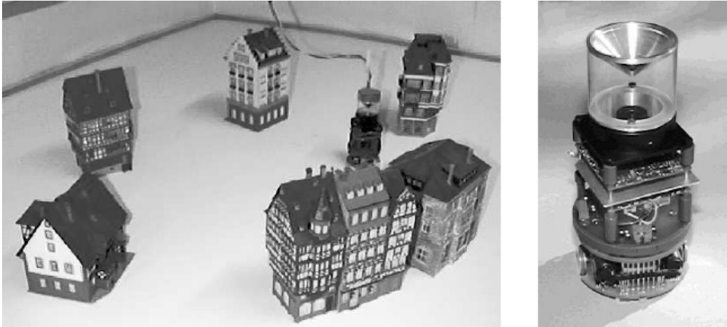
Abb. 19: Roboter mit Kamera, die über einen Panoramaspiegel einen 360°-Rundumblick hat. (Grafik aus Franz et al. 1998)
